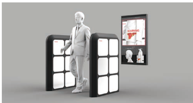
利用毫米波雷达模块开发出穿行式危险品检测系统
