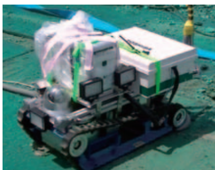
用于福岛第一核电站的能可视化测量放射线的伽马相机
